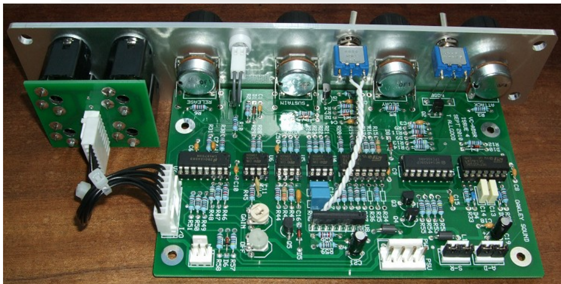
FIGURE 2 – Exemple de module VCA de marque Waldorf destiné à la synthèse modulaire et le PCB "sous le capot" basé sur des circuits SSM2264...
