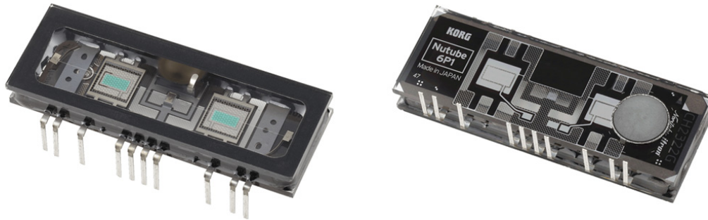
FIGURE 7 – Le nouveau composant "Nutube" intègre deux triodes de préamplification dans un circuit intégré. Par rapport à des triodes/pentodes classiques, ce circuit permet des tensions de polarisation beaucoup plus faibles (autour de 30 à 80 Volts au lieu des 200 à 400V requis pour une triode classique).
