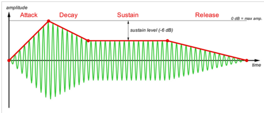
FIGURE 4 – Enveloppe typique d’amplitude de type ADSR (en rouge) et signal audio résultant (en vert).
